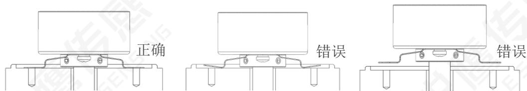
② 将 M3×4 凹端紧定螺钉头部蘸螺纹胶，使用对应内六角扭力扳手将第一颗紧钉螺钉旋入编码器轴内轻锁紧，使其接触电机轴；将第二颗紧钉螺钉旋入编码器轴内，使用 7 kgf·cm 扭力锁紧；再将第一颗螺钉使用 7 kgf·cm 扭力锁紧。
